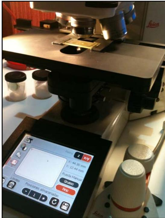
**Figura 7.** Puesta a punto y calibrado de microscopio y platina motorizada.
